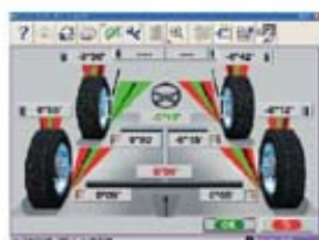
Rápida visualização dos ângulos básicos do alinhamento
